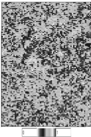
Gambar 4. Hasil Prediksi Volume Shale dengan Teknik PCPT pada Lapisan Kedalaman 750 m
