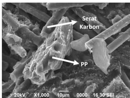
Gambar 10. Permukaan Patahan Spesimen Uji Tarik F1
