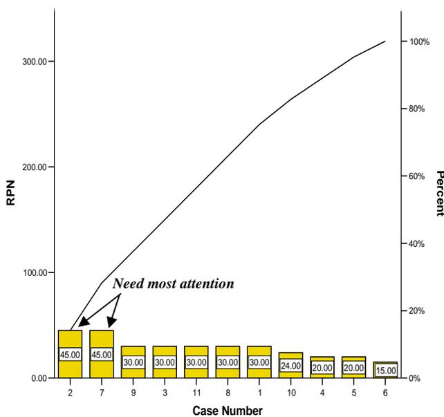
**Keterangan:** 1. Kompresi bocor, 2. Piston aus, 3. Filter udara masuk kotor, 4. Filter udara masuk berkarat, 5. *Main bearing* aus, 6. *Body* filter udara keluar berkarat, 7. Spon filter udara keluar rusak, 8. *Con rod bearing abrasive*, 9. *Valve* bocor, 10. *Liner* aus, 11. Konsumsi oli terlalu banyak
