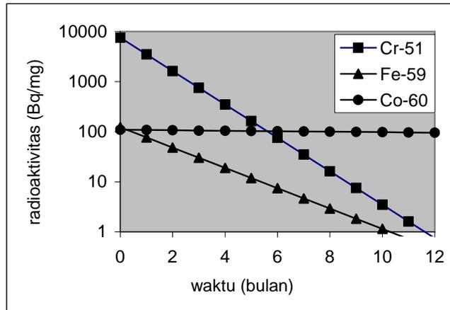
Gambar 2. Radioaktivitas radioisotop <sup>51</sup>Cr, <sup>60</sup>Co dan <sup>59</sup>Fe sejalan dengan waktu peluruhan sampai dengan 12 bulan dihitung berdasarkan radioaktivitas hasil pengukuran spektrometer *gamma*
