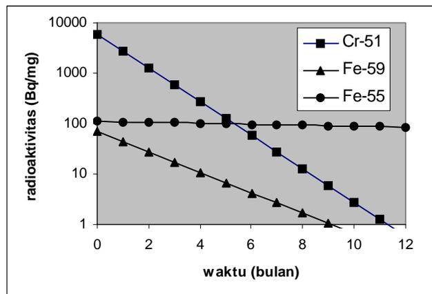
Gambar 3. Radioaktivitas <sup>51</sup>Cr, <sup>59</sup>Fe dan <sup>55</sup>Fe selama 12 bulan setelah iradiasi dari hasil perhitungan
