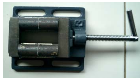
Gambar 4. Penjepitan sampel untuk memastikan pelekatan epoksi secara sempurna.
