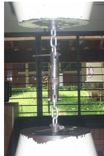
Gambar 5. Modifikasi alat bantu pengujian kekuatan lekatan dengan memasang rantai pada batang penyearah, untuk memberi fleksibilitas antara sampel dan mesin uji.
