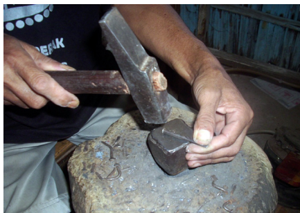
Foto 3. Proses menempa ( tuku ) perak yang sudah dilebur (Sumber: Dokumentasi Pribadi).
