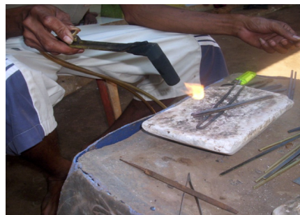
Foto 4. Proses membakar perak yang sudah dilebur (Sumber: Dokumentasi Pribadi).
