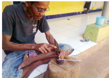
Foto 6. Proses mengukir perak (Sumber: Dokumentasi Pribadi).
