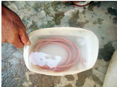
Foto 11. Memasukkan perhiasan ke dalam air perak (Sumber: Dokumentasi Pribadi).
