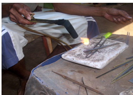
Foto 7. Solder bagian ukiran yang ditempel (Sumber: Dokumentasi Pribadi).
