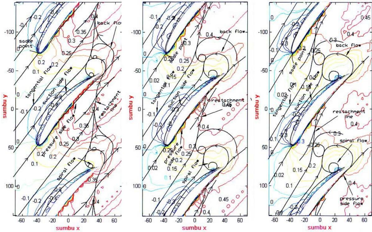
Gambar 9. Sketsa aliran pada *endwall* tanpa *tip-clearance* [8].
