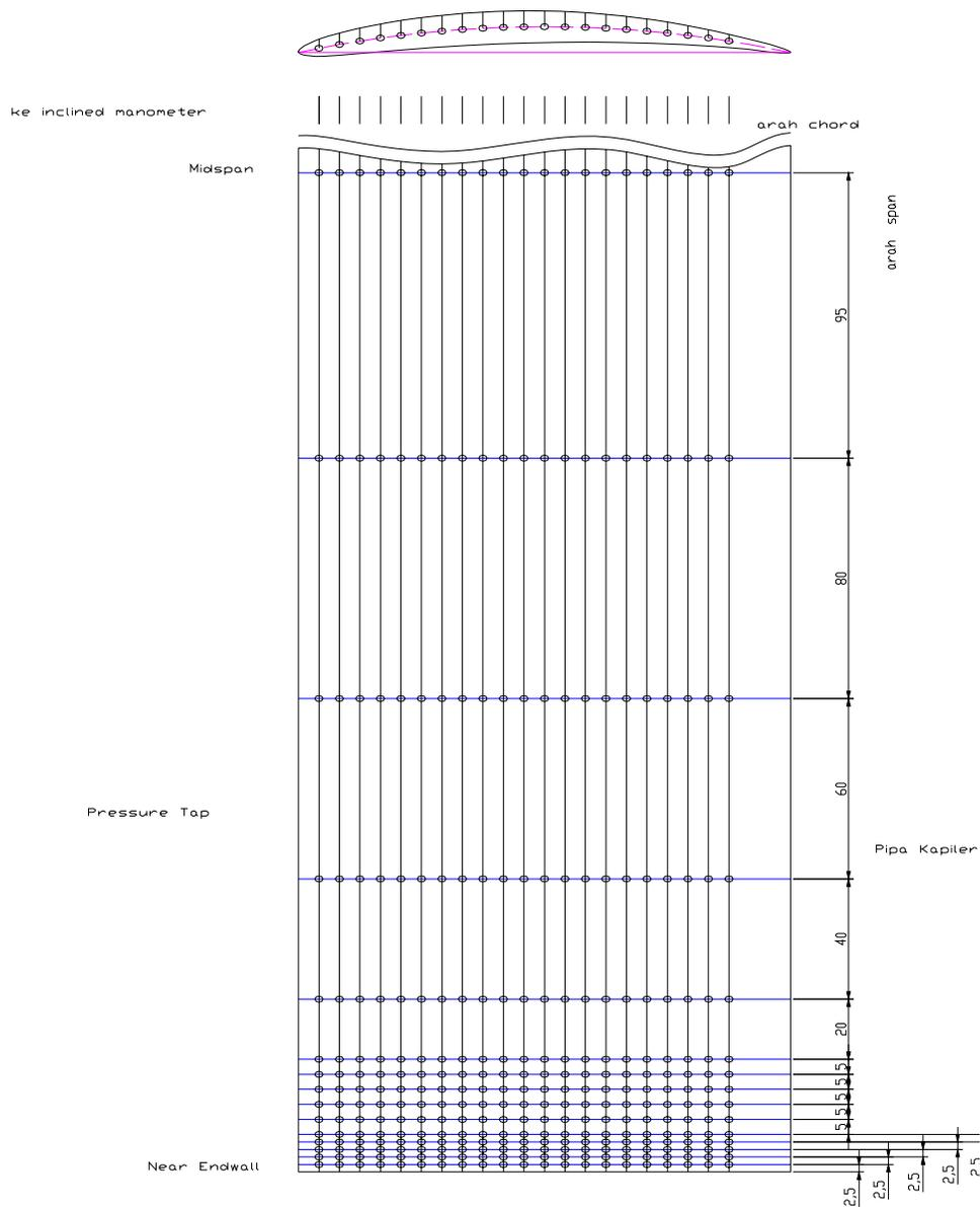
Gambar 4. Daerah pengukuran distribusi tekanan statis pada permukaan *bsurface* dari *midspan* sampai *endwal*
