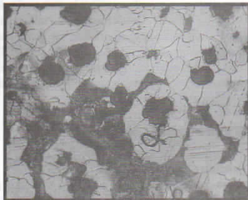
Gambar 3. Foto struktur mikro as-cast A pembesaran 200 X
